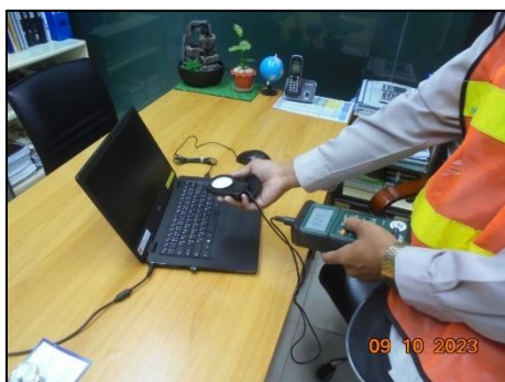
ภาพที่ 3.2.7.3-1 ตัวอย่างการตรวจวัดระดับความเข้มของแสงสว่างในสถานประกอบการ
