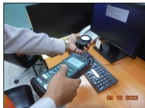
ภาพที่ 3.2.7.3-1 ตัวอย่างการตรวจวัดระดับความเข้มของแสงสว่างในสถานประกอบการ
